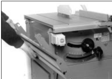
Das Führungsprofil (Kulissentragprofil) in die Aufnahmevorrichtung einhaken.
